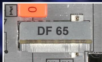
Bei den Verstärkertypen HV 422-65 Vario, HV 422-85 Vario, HV 433-65 Vario, HV 433-85 Vario, HVO 1244 P, HVF 1244 P und Vario 1244 F sind verschiedene Frequenzbereiche im Vor- und Rückweg durch die steckbaren Diplexfilter DF 65 und DF 204 bzw. DF 85 und DF 204 wählbar.
